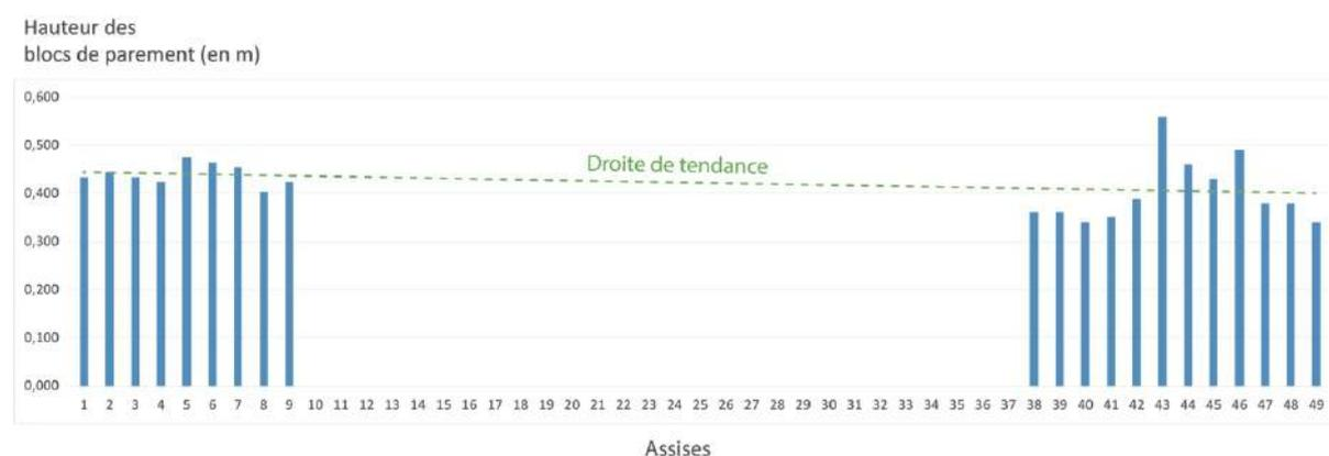
Fig. 2. Hauteurs des assises relevées sur les 19,50 premiers mètres visibles au centre de la face nord de la pyramide de Meïdoum.
